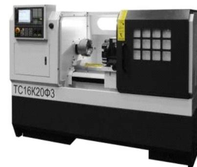
Рисунок 1 – Токарный станок с ЧПУ, модели 16К20Ф3
