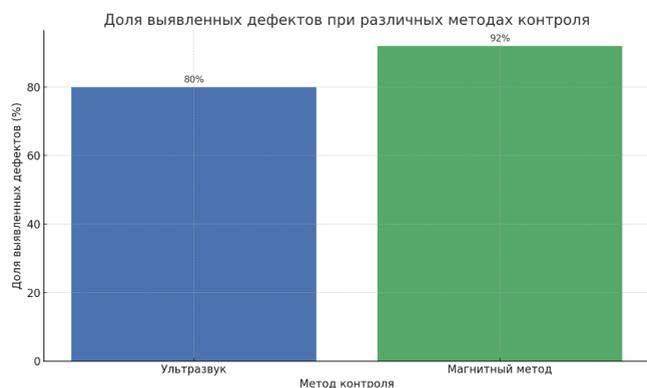
Рисунок – 3 Доля выявленных дефектов при различных методах контроля (ультразвук, магнитный метод)
