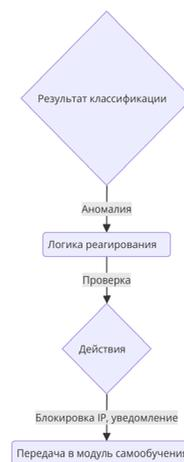
Рисунок 3 – Блок-схема модуля реагирования
