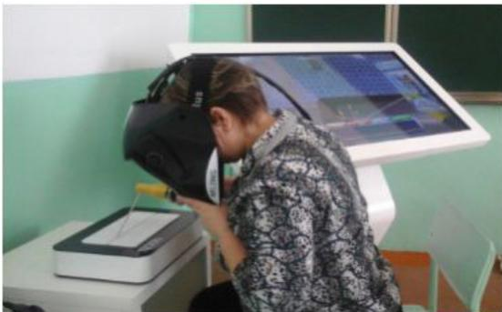
Рисунок 1 – Тренажер для виртуальной сварки
